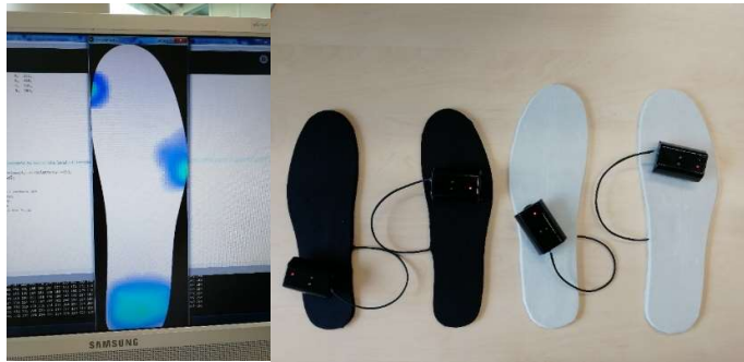
Figure 3. (Droite) : Démonstrateur de semelles instrumentées déclinées en deux pointures (38 et 45 EU). (Gauche) Visualisation et analyse des données en post-traitement.
