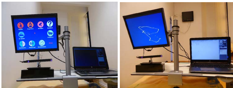
Figure 6 : Interface de communication oeil/machine constituée d'un ordinateur portable gérant l'interaction (à droite sur les photos), d'un écran de communication affichant des items réactifs (à gauche sur les photos), d'un oculomètre déporté (sous l'écran). Ce dispositif, testé au laboratoire et dans un service hospitalier de la Pitié-Salpêtrière, offre plusieurs menus d'interaction ( photo de gauche ), dont le dispositif EOL d'écriture avec les yeux ( photo de droite ).
