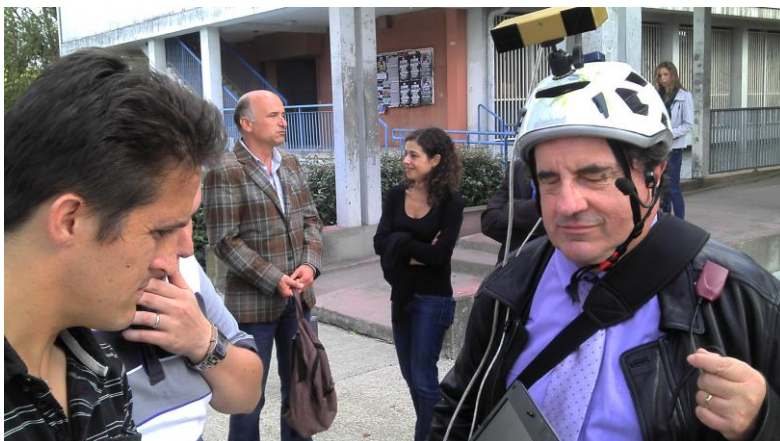
Figure 7 : Prototype V3 incluant une caméra stéréoscopique, un capteur de mouvements de tête, un microphone avec casque osseux et un ordinateur dans un sac à dos. Ici, B. Descargues (CNSA) utilise NAVIG, en présence de M. Mace (IRIT), R. Reclus (Toulouse Métropole) et M. Auvey (LIMSI) lors de la journée de clôture du projet.
