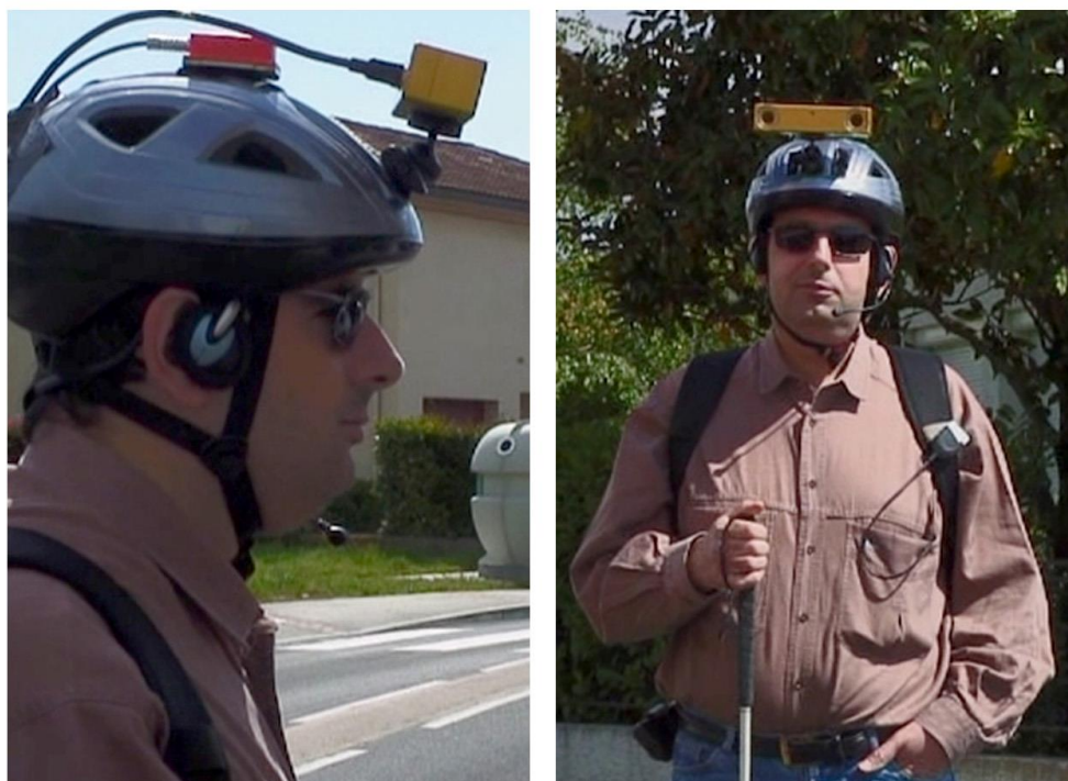
Figure 1 : Bernard Oriola (IRIT) avec le prototype V3 de NAVIG. Ce « prototype de laboratoire » inclut une caméra stéréoscopique, un capteur de mouvements de tête, un GPS avec capteurs à la hanche, un microphone avec casque stéréo (le casque peut être remplacé par un casque à conduction osseuse) et un ordinateur dans un sac à dos.
