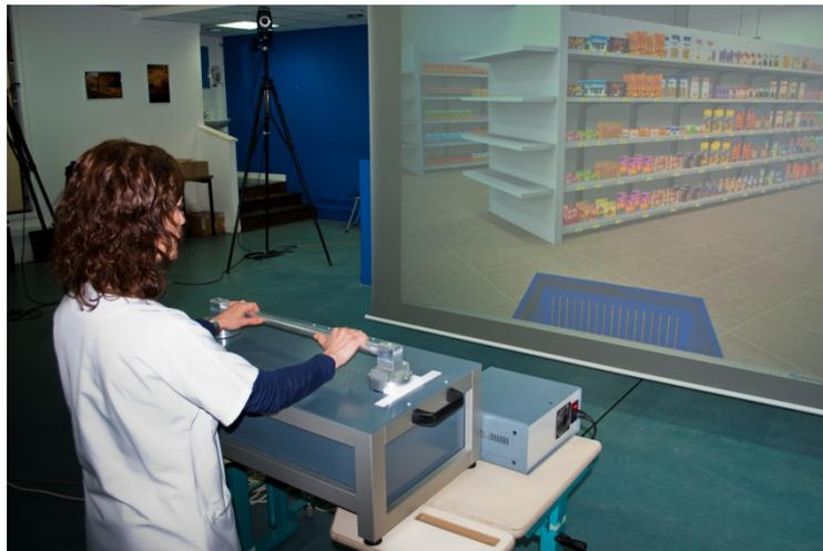
*Fig. 1 : Déplacement dans le supermarché virtuel. Un caddie virtuel permet de se déplacer dans le supermarché et offre un retour d'effort fonction du poids des produits dans le caddie et des collisions éventuelles avec le mobilier.*
